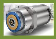
电主轴将电机集成于主轴单元内,因高转速运行产生的大量 热量所导致的温度升高会使主轴热态和动态性能变差,从而影响 电主轴的正常工作。目前,机床普遍采取了循环油冷或水冷技术,对电主轴的定子及主轴轴承进行循环冷却,强制性地带走主轴高速旋转所产生的热量。同时,为了减少主轴轴承的发热,还必须对轴承进行合理的润滑。
